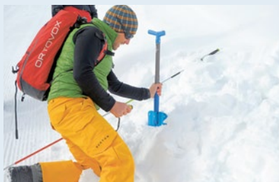
Die richtige Schaufel hat einen T- oder noch besser: einen genügend grossen D-förmigen Handgriff
