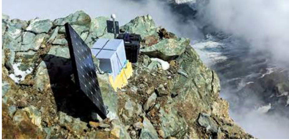
Seismometer auf 4470 m ü. M. unmittelbar unterhalb des Matterhorn-Gipfels (Foto: Samuel Weber, SLF)
